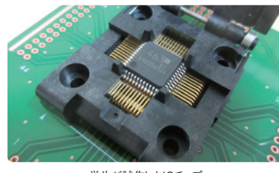
学生が試作したICチップ (チップパッケージにKYUの文字が見える)
